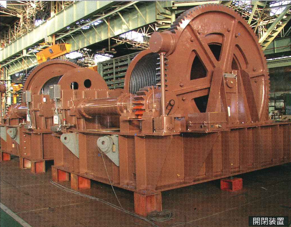
高圧スライドゲート ジェットフローゲート
